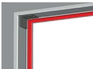
Joint d'étanchéité EPDM sur dormant
